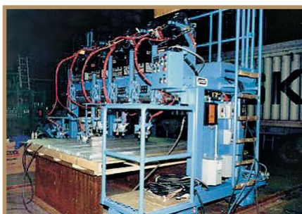
система для сварки алюминиевого пола
