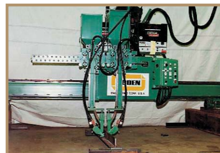
Dart Welder – система сварки с возможностью отклонения горелки в значительном диапазоне
