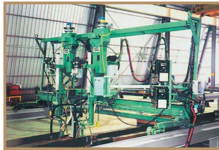
Dart IV – передвижная система для сварки под флюсом
