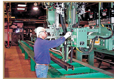
Dart 2108 – сварка двойных швов большой длины в мостостроении
