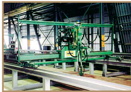
Dart 2102 – сварка двойных швов на рёбрах жёсткости пролётов мостов
